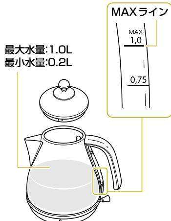
※最小水量以下の水量では、空焚き防止機能が働いて、本体内的安全装置が作動し、自動的に加熱を終了します。空焚き防止機能が働いたときは、電源プラグを抜き、本体が冷めるまで待ってからお使いください。
