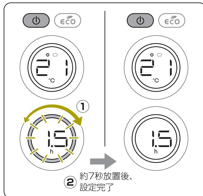
\* タイマー運転中にタイマー設定ノブを回すと、残り時間が約5秒間点滅表示されます。
