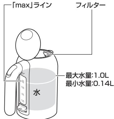
※最小水量以下の水量では、空焚き防止機能が働いて、本体内の安全装置が作動し、自動的に切れます。空焚き防止機能が働いたときは、電源プラグを抜き、本体が冷めるまで待ってからお使いください。
