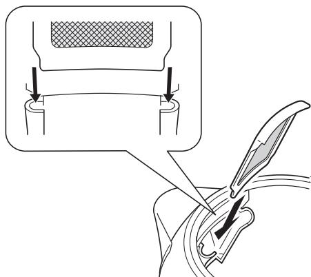
フィルターを注ぎ口の内側にある溝に合わせ、カチッという音がするまで押し込みます。
