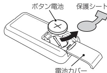
電池カバーを開けて、保護シートを取り外します。
