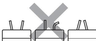
電源プラグ(刃)が変形した場合は、販売店または当社にプラグの交換をご依頼ください。曲がった刃は、接触不良時の発熱により、コンセントの刃受を変形させる原因になります。(曲がった刃をペンチなどで手直ししないでください。)
