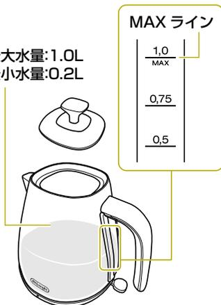
※最小水量以下の水量では、空焚き防止機能が働いて、本体内の安全装置が作動し、自動的に加熱を終了します。空焚き防止機能が働いたときは、電源プラグを抜き、本体が冷めるまで待ってからお使いください。
