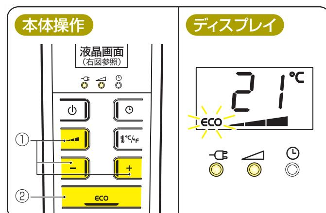
ヒーターは温度センサー付近の周辺温度を感知し、設定した温度を保つよう自動的に暖房のオン・オフを繰り返します。また、電力レベルランプは暖房の稼働状況に応じて、消点灯を繰り返します（ディスプレイの電力レベル設定表示は稼働状況に応じて変わらず、常に設定した電力レベルが表示されます）。
