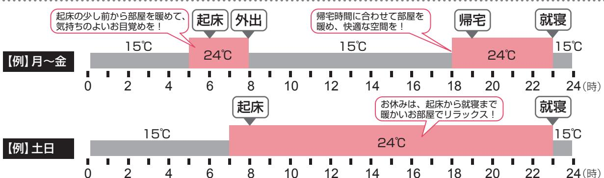
平日は、起床時と夕方帰宅してから就寝まで高めの設定温度（＊モード）で運転。それ以外の時間帯は低めの設定温度（●モード）で運転。
