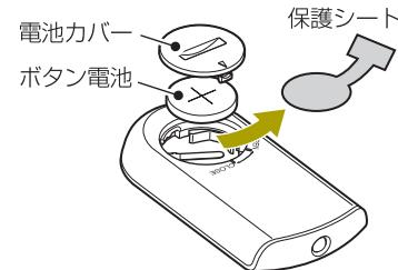
電池カバーを開けて、保護シートを取り外します。電池カバーの開けかた／閉めかたは、9ページの「リモコンの電池交換」を参照してください。
