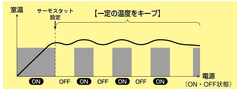
お部屋が適温になったと感じたら、パイロットランプが消えるポイントまでダイヤルを戻します。
