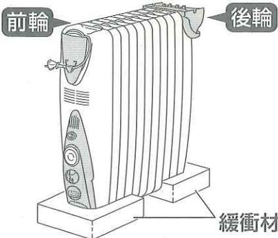
本体の底面を上向きにして、所定の位置に車輪を取り付けます。
