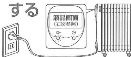
電源を接続し、時刻設定用の時セットボタンと分セットボタンで、現在時刻を設定します。
