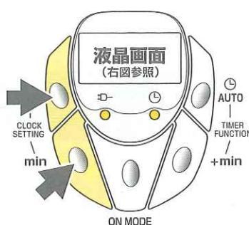
最初に、時刻設定用の時セットボタンおよび分セットボタンを押し(※)、ご希望の運転開始時刻を設定します(→画面上部にAUTOの表示)。
