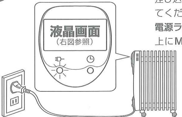
差込みプラグを壁面のコンセントに直接差し込みます。根元までしっかりと入れてください。
