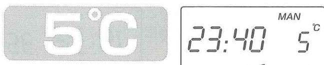
温度調節ボタン(ー)を押して温度を「5°C」に設定する(電力レベルは▲)と、ヒーターの周辺温度が5°C以下になった場合に自動的に運転を開始し、ヒーターの凍結を防止します。
