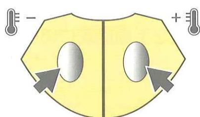
温度調節ボタン(+または-)を押して、ご希望の温度(5~35°C)を設定します。その後、電子サーモスタットが周辺温度(=温度センサーが1秒毎に測定した温度)に応じて電力レベルを自動制御(※)し、設定した温度(設定温度)を保ちます。
