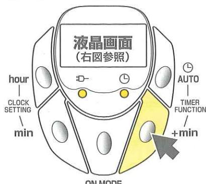
運転時間設定ボタンを押して、ご希望の運転時間(全6種：以下参照)を選択／設定します。
