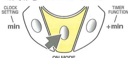
手動運転ボタンを押し、電力レベルを〇(運転停止)にします。使用後は、差込みプラグをコンセントから抜きます(→画面表示と電源ランプが消える)。
