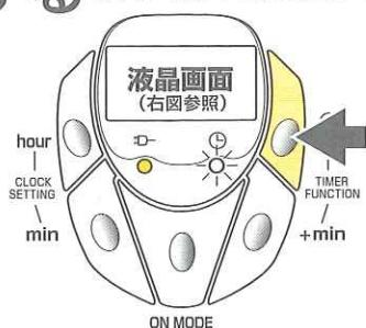
デジタルタイマーに予約(内容：暖房の運転開始時刻、運転時間、温度)を設定するには、タイマー予約ボタンを押します。1回押すと予約A、2回押すと予約bの未設定画面になり、タイマー運転ランプが点灯します。
