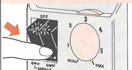
電力切替えスイッチを2つとも押し込みます。(※オイルを早く暖めるために、運転当初は電力を最大にします。)パイロットランプが点灯し、暖房が始まります。
