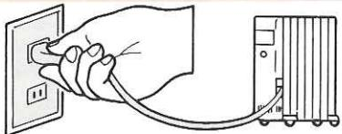
差込みプラグを壁面コンセントに直接差し込みます。
