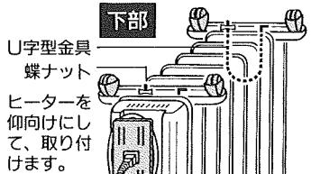
キャスター2台を、U字型金具と蝶ナットで、ヒーター本体下部の両端に固定します。
