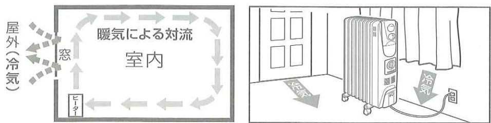
室内で、特に冷気のダウンドラフト（冷気の侵入）が発生しやすい場所＝窓の下や外気に触れている壁際などに設置してください。ヒーターの暖気による“エアカーテン”で、ダウンドラフトの発生を抑えます。また、窓に厚手のカーテンをしたり、ドアの開閉頻度を減らすなどの工夫をすることで、より効果的な暖房が得られます。
