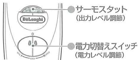
サーモスタッフと電力切替えスイッチの両方を上手に活用することで、ムダな暖め過ぎを防ぎます。お部屋が暖まったら、「出力レベル」および「電力レベル」を下げるようにしてください。
