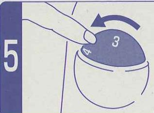
お望みの室温になったら、サーモスタットをゆっくりと左に回し、パイロットランプが消えたところで止めます。これで適温がセットされ、あとは自動的に適温が保たれます。
