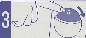
サーモスタットのダイヤルを右いっぱい(最大数まで)回し、出力レベルを最大にセットします。
