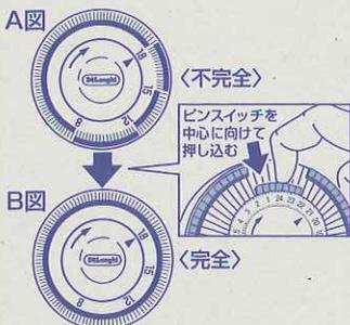
暖房の開始/停止を電力切替えスイッチで行う=手動運転は、**タイマーが作動しない状態**(B図:ピンスイッチが全て内側にある)で行います。
