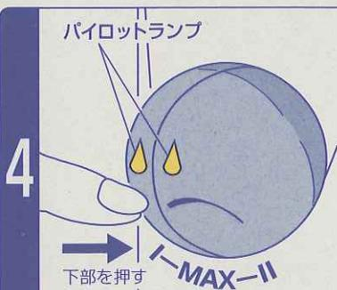
電力切替えスイッチを入れます。運転当初は、早く暖めるため、両方のスイッチを入れて(※電力を最大にして)ください。パイロットランプが点灯し、暖房運転が始まります。
