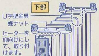
キャスター2組を、U字型金具と蝶ナットで、ヒーター本体下部の両端に固定します。
