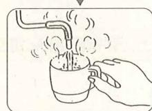
●蒸気は、牛乳やスープなど(液体)の温めに利用できます。スチーム管の先には、ノズルを取り付けてください。
