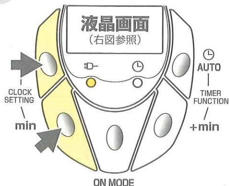
現在時刻を設定する場合は、時報などに合わせ、時セットボタンおよび分セットボタンを押します(※)。数字(時刻)の点滅が点灯に変わると、設定の完了です。
