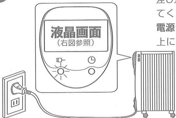
差込みプラグを壁面のコンセントに直接差し込みます。根元までしっかりと入れてください。
