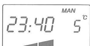
温度調節ボタン(ー)を押して温度を「5°C」に設定する(電力レベルは▲)と、ヒーターの周辺温度が5°C以下になった場合に自動的に運転を開始し、ヒーターの凍結を防止します。
