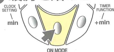
手動運転ボタンを2回押し、電力レベルを▲(※)に設定します(→運転開始)。
