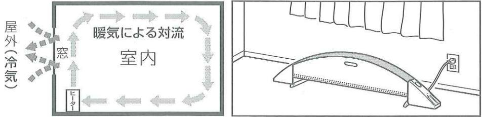
室内で、特に冷気のダウンドラフト(下降気流)が発生しやすい場所＝窓の下や外気に触れている壁際などに設置してください。ヒーターの暖気による“エアカーテン”で、ダウンドラフトの発生を抑えます。また、窓に厚手のカーテンをしたり、ドアの開閉頻度を減らすなどの工夫をすることで、より効果的な暖房が得られます。
