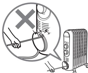
収納するときは、電源コードをコードホルダーに強く巻きつけないでください。電源コードを強く巻きつけると、コードの接続部が傷み、火災や感電の原因になります。
